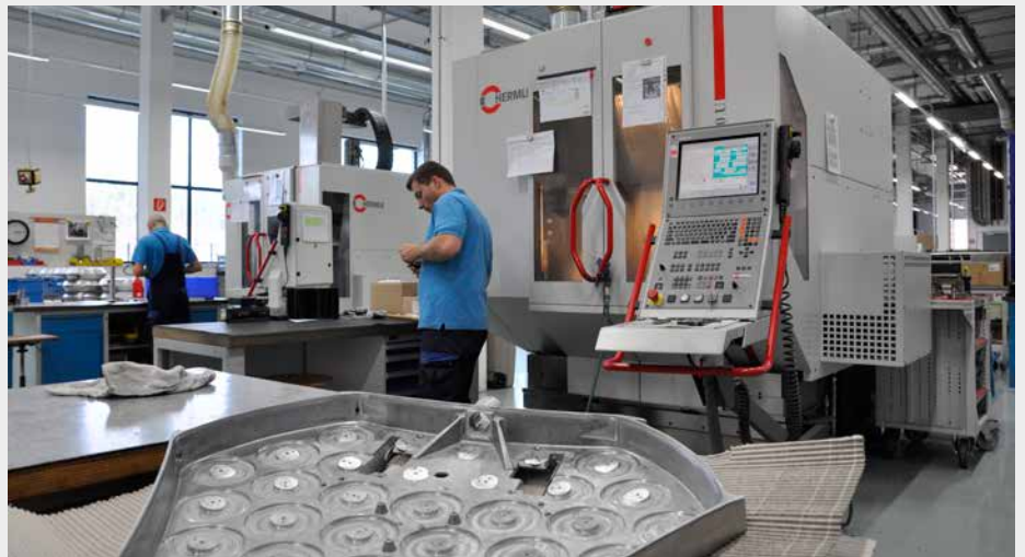
Das Gussteil wird in einer Aufspannung bearbeitet.
