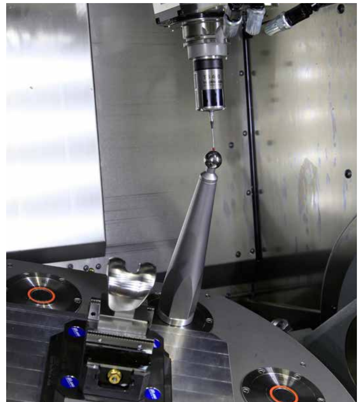
Die TNC-Funktion KinematicsOpt vermisst Dreh- und Schwenkachsen mit Hilfe einer Kalibrierkugel einfach und schnell. Die möglichen Abweichungen werden über die Kinematiktafel kompensiert – je nach Kundenwunsch auch mit Protokoll.
