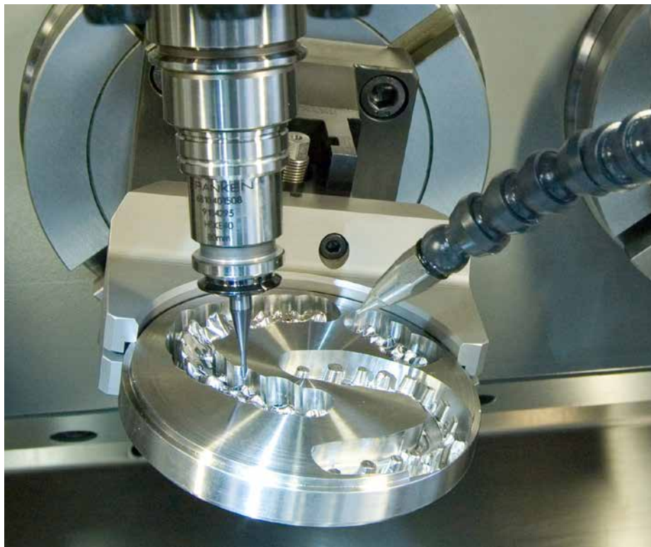
Hohe Genauigkeit, kurze Bearbeitungszeit und optimale Oberfläche einer Brücke.
