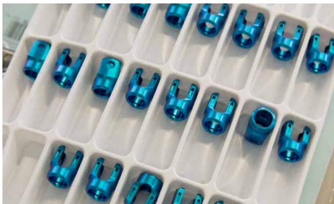
Titan-Implantate, die an der Wirbelsäule eingesetzt werden. Mit der iTNC 530 erreicht die Leitner AG brillante Oberflächen und spart sich aufwendige Nacharbeit.
