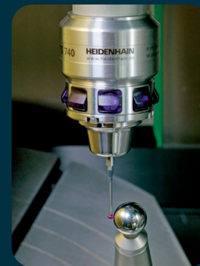
Mit KinematicsOpt ist die Maschinenkinematik immer perfekt kalibriert.
