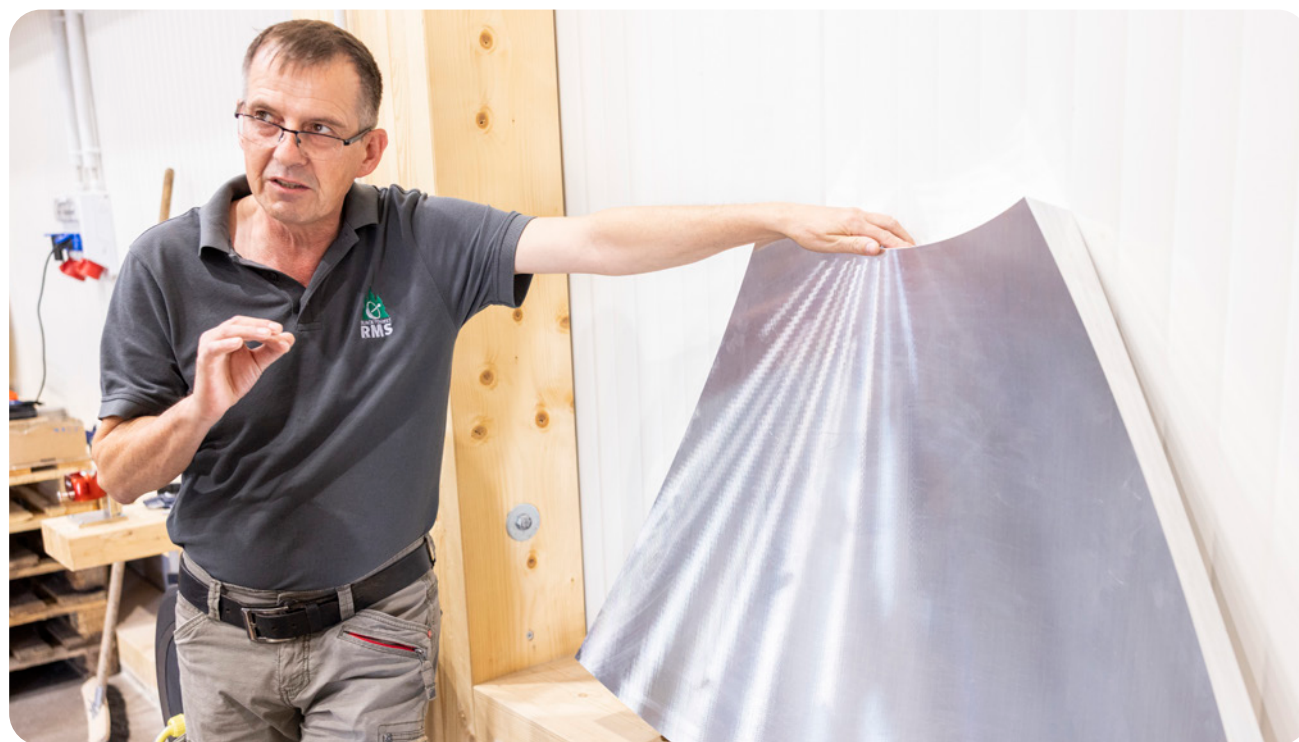
Bei den Glanzbauteilen wird auf der Oberfläche des Werkstücks das Regelverhalten der Maschine sichtbar.
