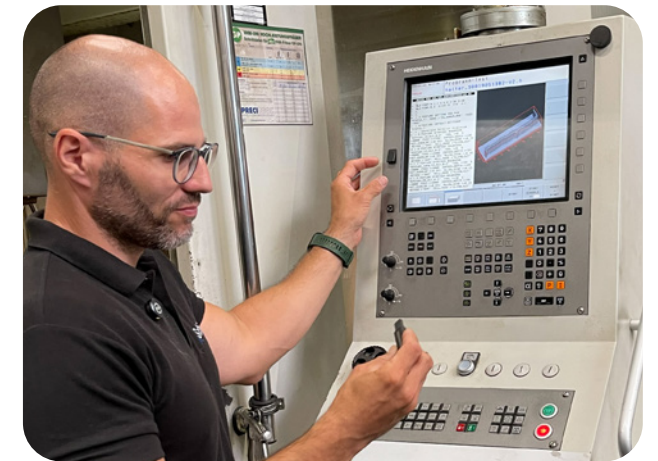
Die Übertragung der fertigen Programme erfolgt einfach per USB-Stick.
