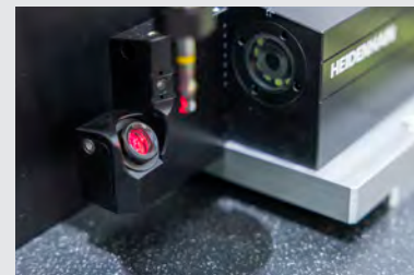
Werkzeugdurchmesser und -länge messen
