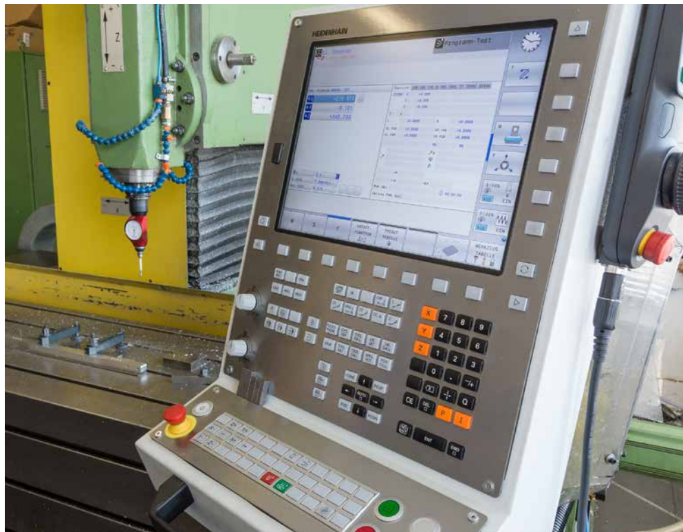
Das Arbeiten an der TNC 320 ist mit dem 15 Zoll großen TFT-Farb-Flachbildschirm komfortabel.
