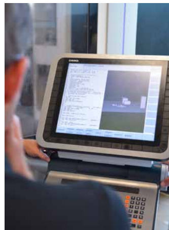
Anspruchsvolle Teile einfach programmieren: HEIDENHAIN iTNC 530 an Deckel Maho-Bearbeitungszentrum
